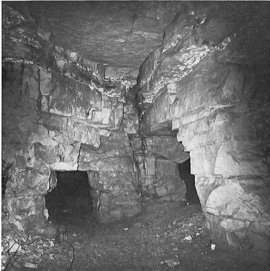
Fig. 4. — Exploitation par piliers tournés.
