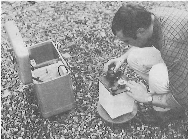
Fig. 4 : Gravimètre Lacoste et Romberg modèle D.
